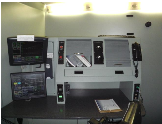
透過後方的電腦(左圖)，教練可以制造各種飛行狀況給學員，而模擬機的座艙(右圖)則與實機幾乎相同，提供學員無比的真實感。
