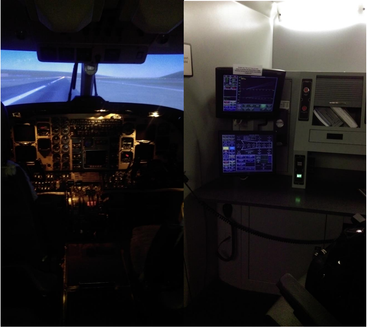
通電起動後的模擬機，前方影像則是透過模擬機上方的三臺影像產生投影機來顯示。
