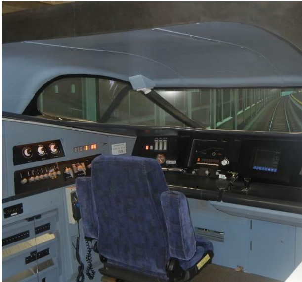
圖3-42：可模擬集電弓升降的駕駛模擬機
