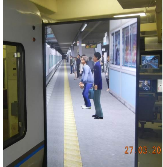
圖3-45：訓練列車長的列車模擬機，可設定各種情境訓練列車長開關車門的反應
