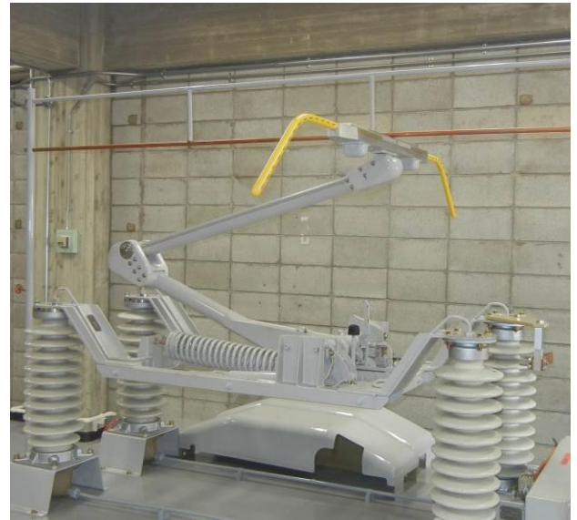
圖3-42：可模擬集電弓升降的駕駛模擬機
