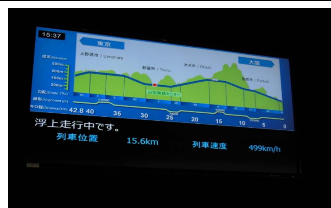
照片 5.12 實驗線磁浮列車行駛位置與速度
