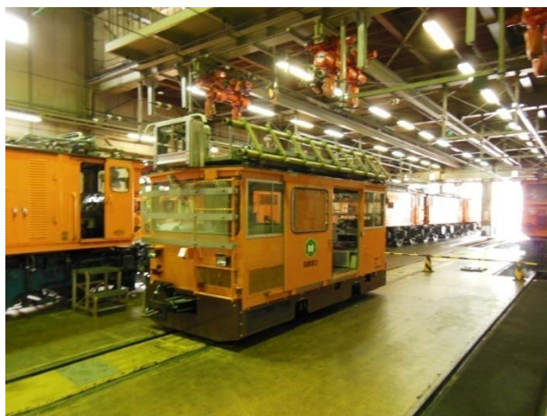
照片 3.21 車庫內每天路線巡視用保線車
