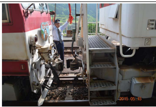
照片 6.8 ED901 電力機車辦理連結
