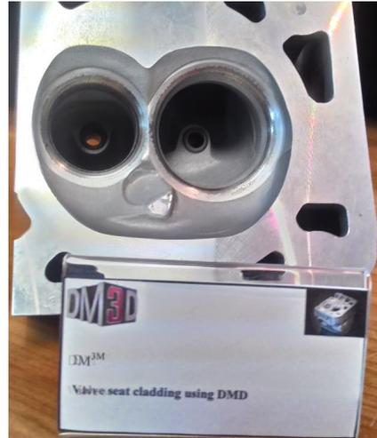
圖 15(1)、(2): DMD 加工成品，包含黃銅與不鏽鋼結合製作的曲面杯、不同材料堆疊成具有不同彈性係數的複合層零組件、在汽缸閥門座上製作硬化層等等汽車、航太上的實際應用案例
