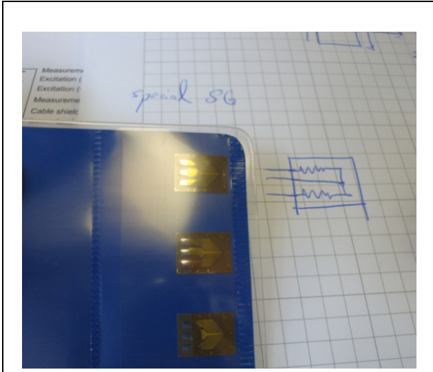
圖 四十：預先封裝好的半橋式應變規
