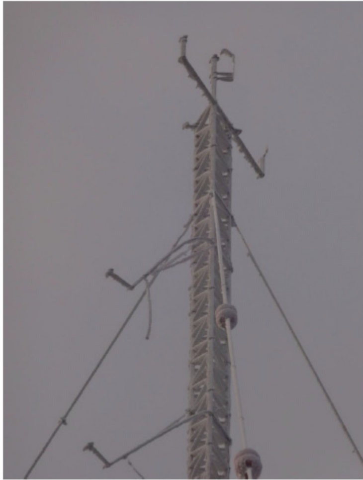
圖 十二：氣象塔上儀器結冰狀況
