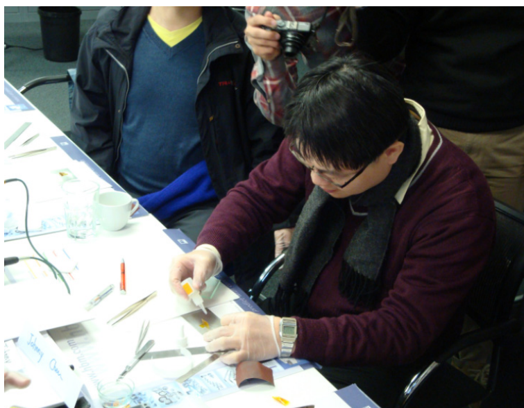
圖 二十四：以瞬間膠固定應變規
