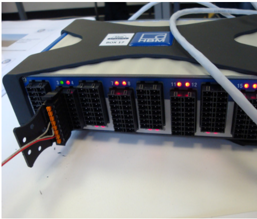
圖 三十四：訊號線端子座與電橋式感測模組連結
