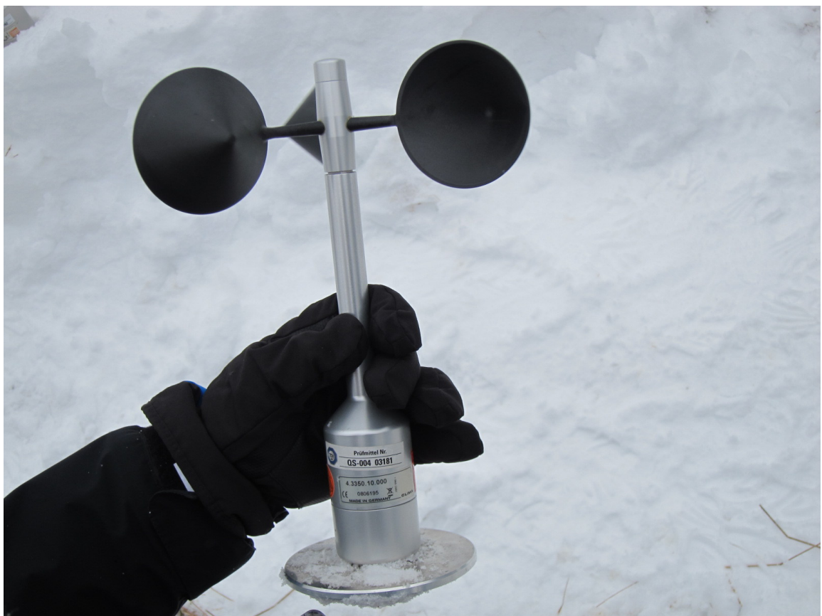
圖 七十：氣象塔上之風速計
