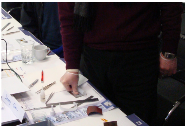
圖 二十五：覆以鐵弗龍紙按壓 1 分鐘以固定應變規
