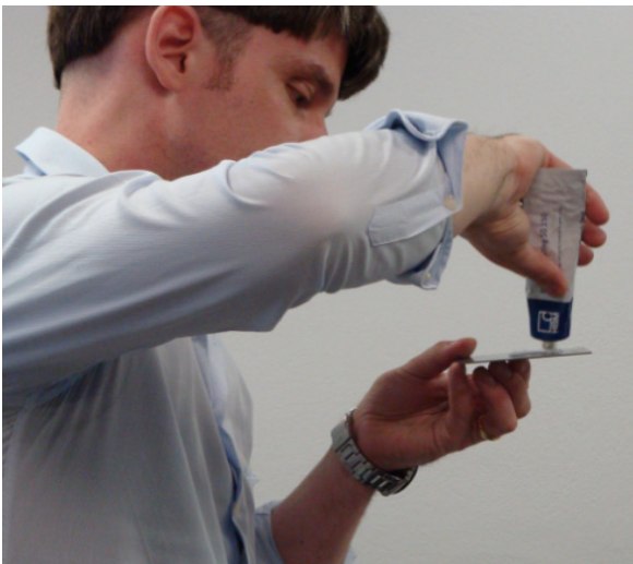
圖 二十八：於樣品上覆以透明膠體以保護應變規
