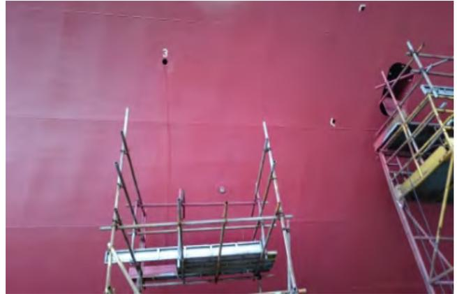
排海閥孔、船底排水孔、船體接合處焊道外板油漆檢查。
