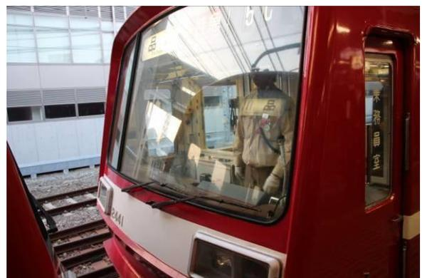
圖 3.4-22 京急電鐵列車自動連結器動作作業
