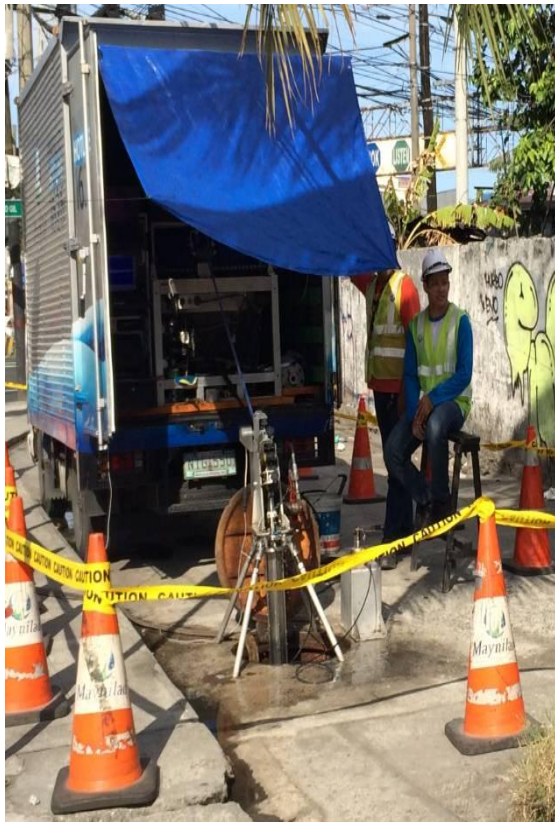
圖 7 Sahara 測漏現場觀摩-現場設備佈建情形
