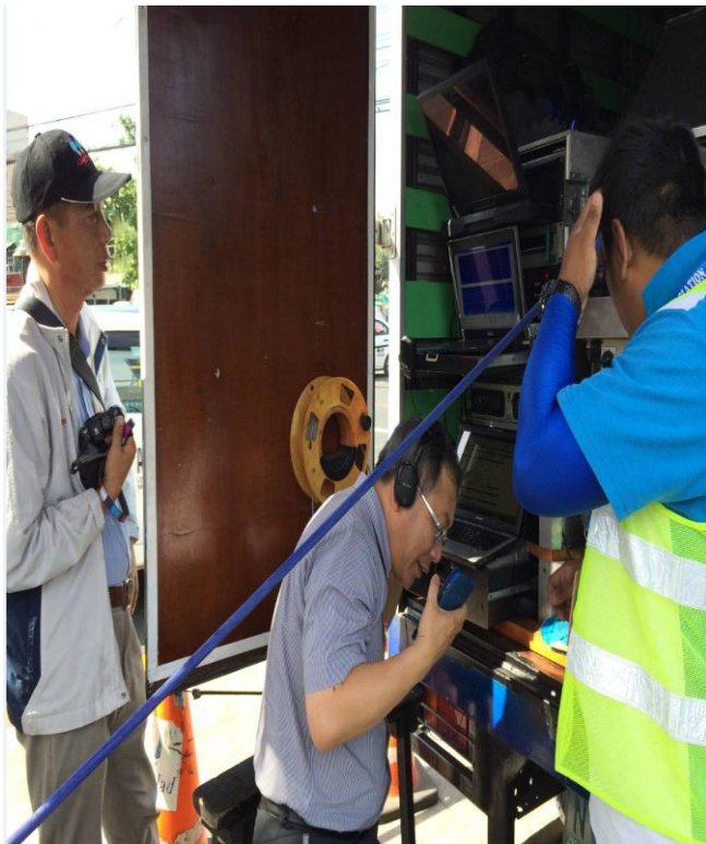
圖 9 Sahara 測漏現場觀摩-模擬漏水時聽漏
