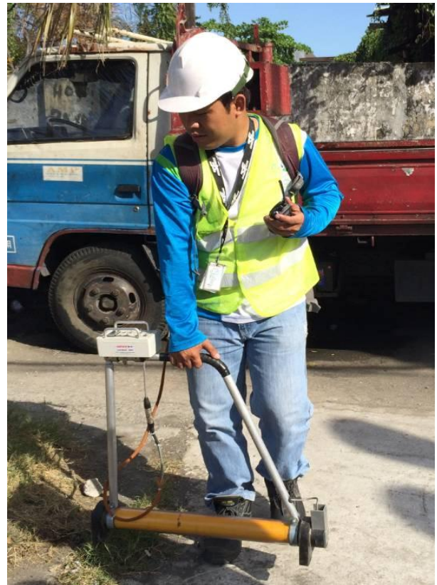
圖 10 Sahara 測漏現場觀摩-在地面追蹤位於管路中之勘測裝置
