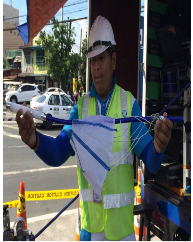
圖 8 Sahara 測漏現場觀摩-幹管鑿開洞口及勘測裝置
