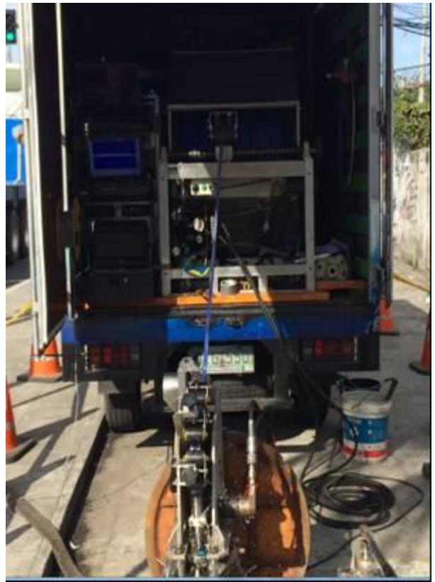
圖 7 Sahara 測漏現場觀摩-現場設備佈建情形
