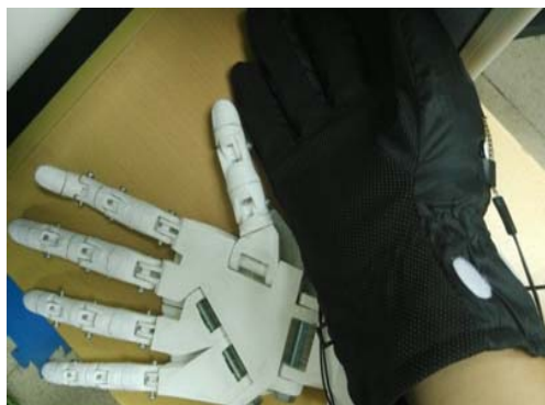
圖 6：健康受試者使用我們暨大自行研發的復健機電手，進行功能性評估及數據收集。
