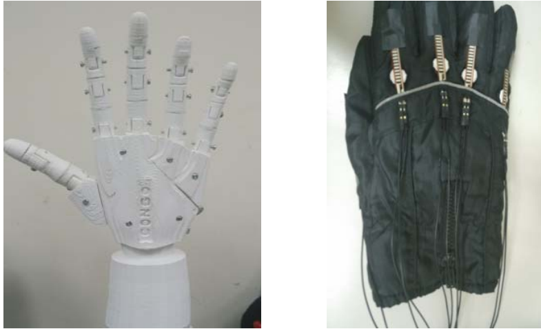
圖 5：我們暨大自行研發的復健機電手。左圖是復健機電手的機器手臂，右圖是復健機電手的專用手套，手套是被穿戴在使用者的手上。
