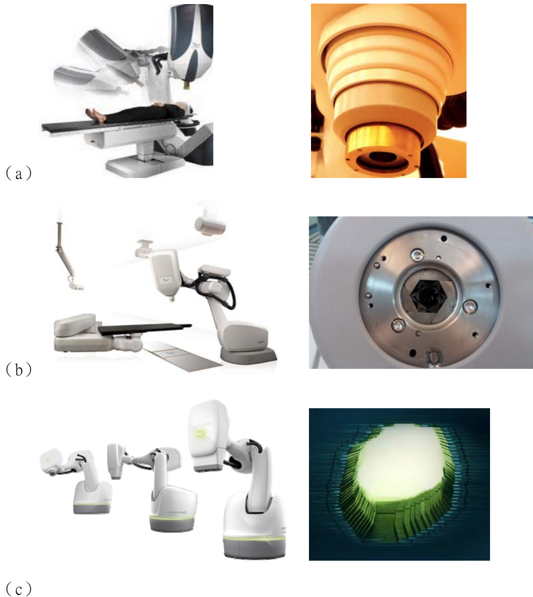
圖 27：電腦刀的發展。(a) 為第三代（型號為 G3），主要還是固定型準直儀，劑量率僅有 400 MU/分鐘；(b) 為第四代（型號為 G4），提供可變光圈準直儀，以模擬固定型準直儀並劑量率增加至 800 MU/分鐘，以縮短治療時間；(c) 為第六代（型號為 M6），保留固定型準直儀及可變光圈準直儀，並新增多葉式準直儀（最大照野為 12x10 公分），劑量率提高至 1000 MU/分鐘。
