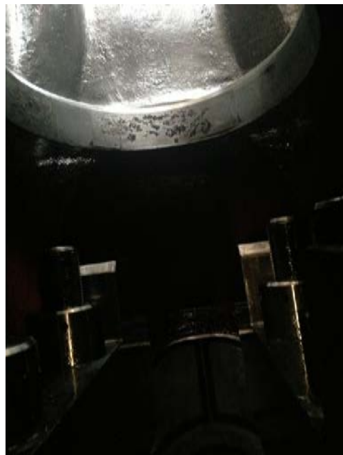
圖 6. 引擎本體內部鏽蝕情形。
