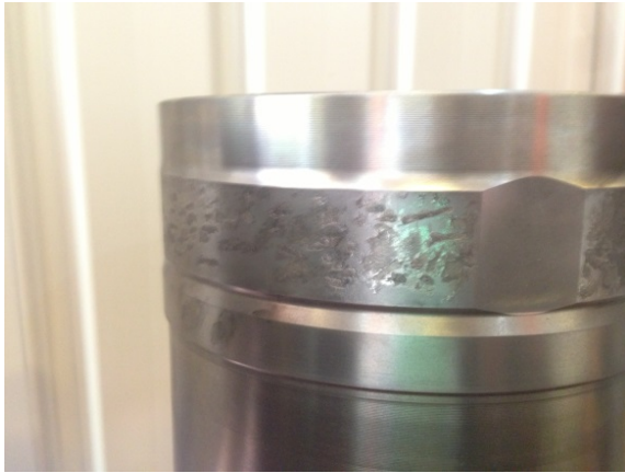
圖 7. 缸套外部鏽蝕情形。
