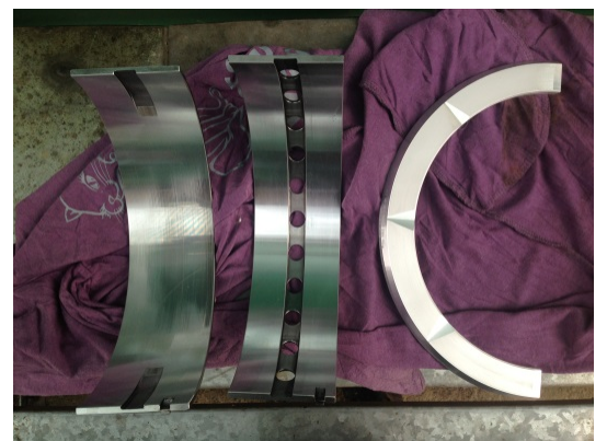
圖 12. 主軸承軸瓦及推力磨損情形。
