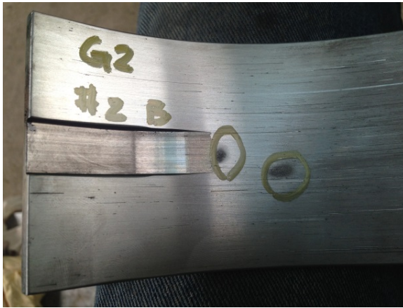
圖 15. 主軸承軸瓦磨損情形。
