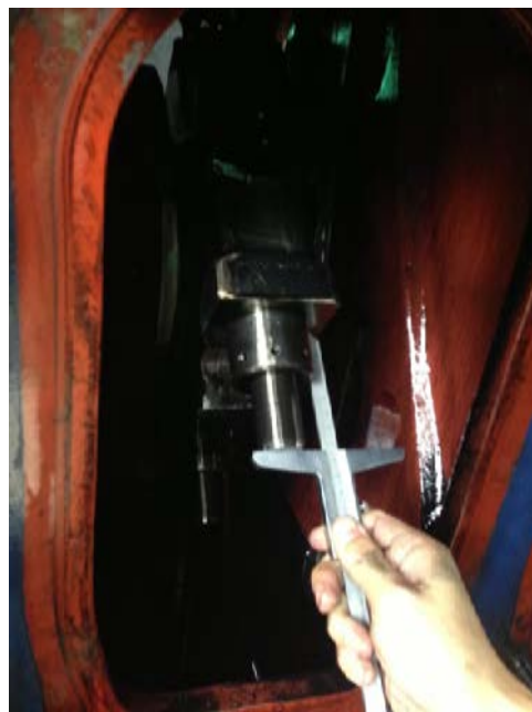
圖 2. 大端螺桿尺寸量測。
