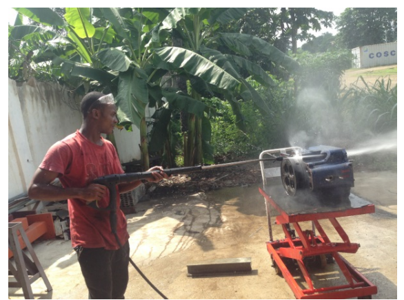
圖 10. 缸頭用高壓水柱清潔。
