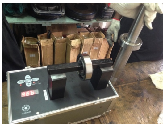
圖 11. 冷卻水泵軸承加熱。
