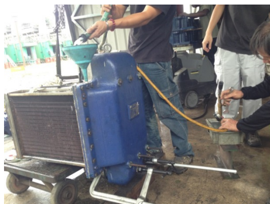
圖 6. 空氣冷卻器試壓。
