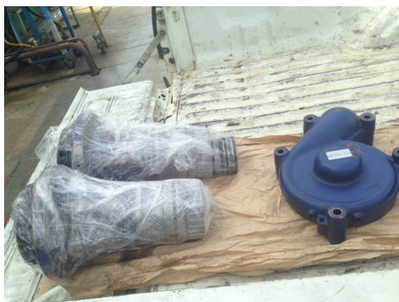
圖 17. 冷卻水泵檢修完成。
