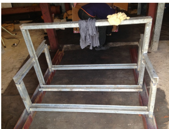
圖 11. 自製增壓機檢修固定架。
