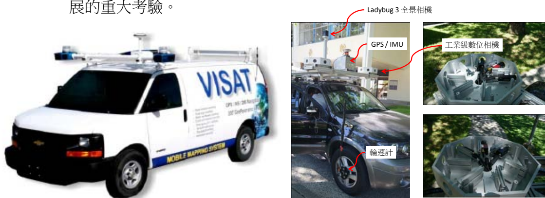
圖 1: 移動式製圖系統：（左）VISAT System & （右）本部多平台製圖技術工作案鷹眼平台
