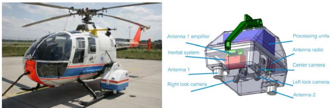
圖 5: (左) 安裝 4K 系統之 BO-105 輕型直升機、(右) 4K 系統之各式元件配置 ©F. Kurz, D. Rosenbaum/ ISPRS Technical Commission I Symposium (Volume XL-1-189)
