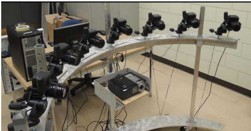
圖 19:多相機系統@Datchev / ISPRS Technical Commission I Symposium (Volume XL-1-101)
