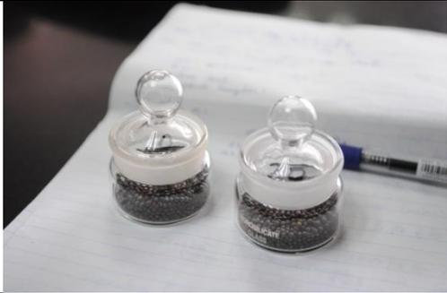
圖九、IARI 種子檢查實驗室使用烘箱法進行種子水分含量測定，惟乾燥皿規格不符合 ISTA 規範(直徑須大於 5 cm)。
