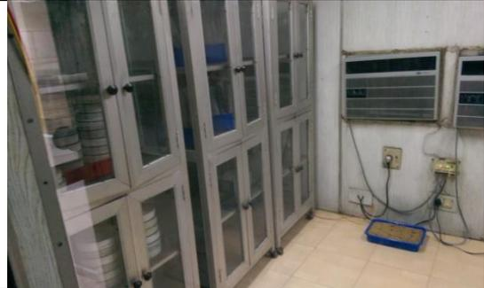
圖十二、IARI 種子檢查實驗室生長箱由窗型冷氣及加熱器控制溫度恆定。
