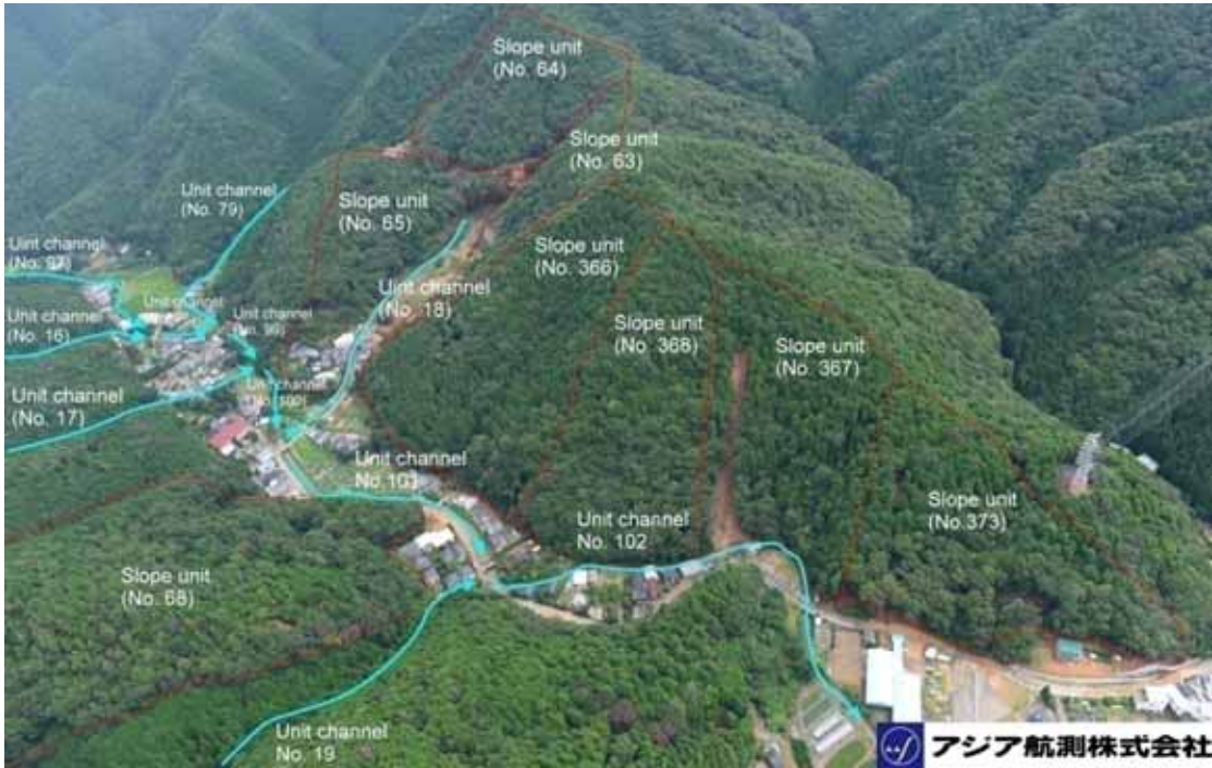
圖 6.13 單位河道 No.102 鄰近坡面崩塌及淹水情形(修改自アジア航空株式會社，2012)
