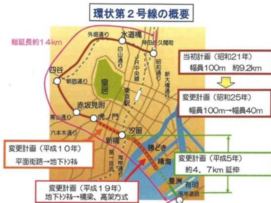
圖八 環狀二號線工程簡介圖
