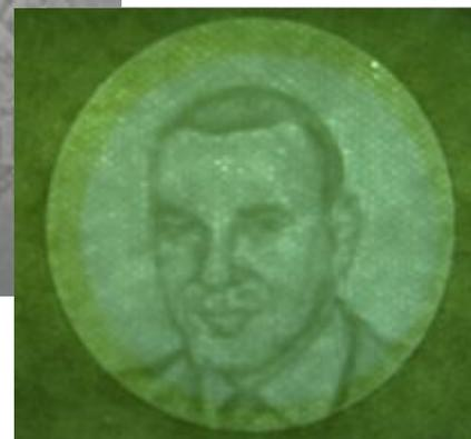
先製作生產模鑄水印所需之銅絲網，一般約 2~4 層，且每兩層為一組使用相同之網屏製作，分粗細不同，如此製作之模鑄水印才能夠產生如 3D 效
