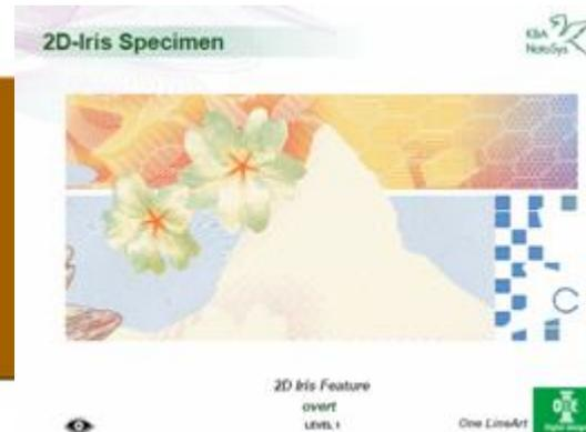
Chablon)，包覆於 2D-IRIS 滾筒之上，此兩組滾筒於印刷時依設定同步做不同幅度之上下左右及頻率運轉。壓力的調整則依需求而定，並沒有一定的數值參考。間接產生不同差異效果的圖案 (如附件 1 資料)。
