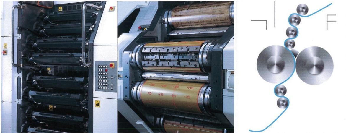
是張頁式雙面多色平凸版印刷機，可同時印刷紙張的正反面，採用 Blanket to Blanket 的壓印印刷方式，兩個橡皮滾筒各自與四塊印版接觸，使用特殊三層軸承來達到超精細線印刷，
