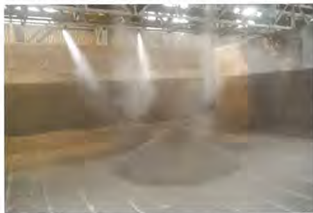
ミスト散布による粉じん飛散抑制試験
