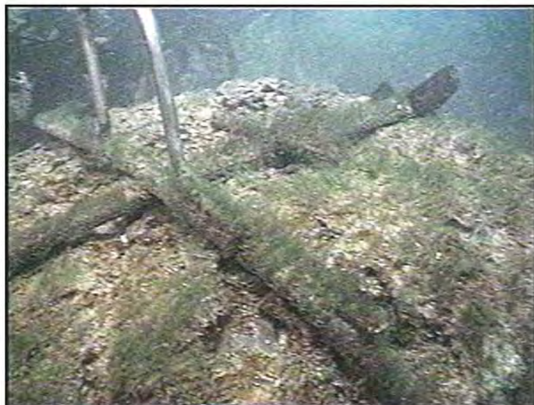
図-24 1ヵ月後の人工石（45×45×40cm）の状況 （八戸市鮫漁港付近）
