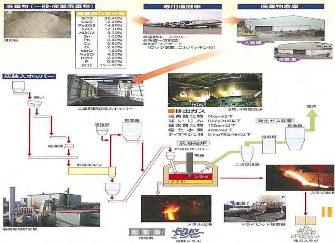
図-1 熔融固化システムフロー
