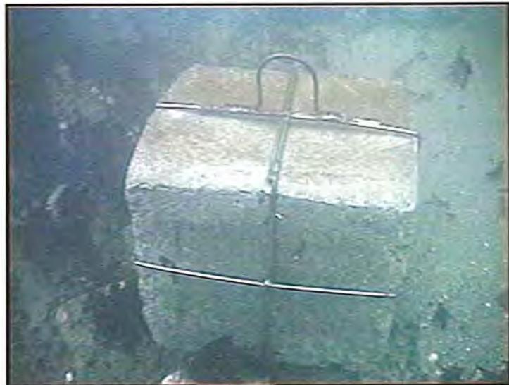
図-23 1ヵ月後のコンクリート (75×75×75cm) の状況 (八戸市鮫漁港付近)
