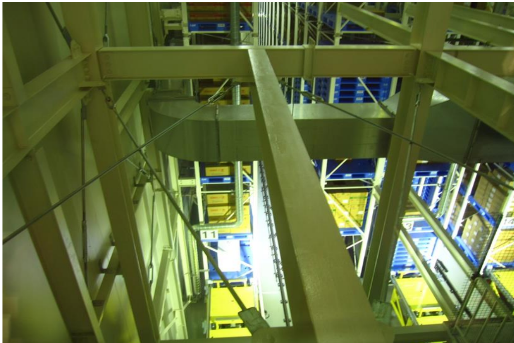
圖六、化血研公司物流配送中心之冷藏立體自動倉庫一隅。
