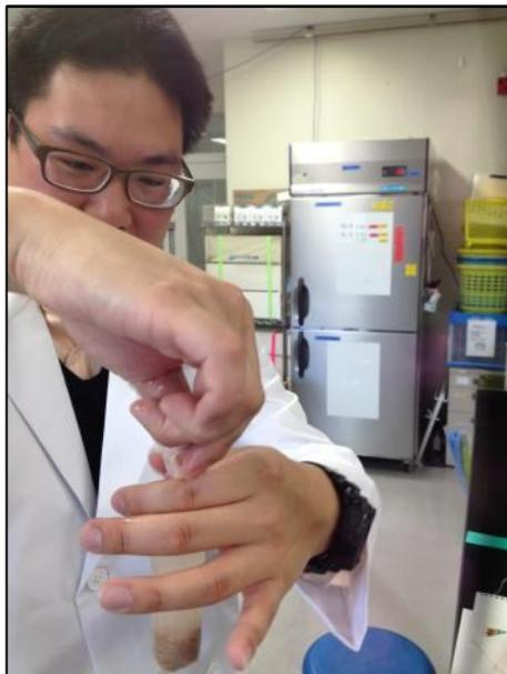
圖 51、按壓透析膜開口端小心擠壓透析膜將膜內氣體趕出(A)，並將透析膜打結(B)。
