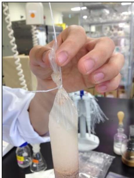
圖 52、透析膜打結(A)，並於打結處綁上塑膠繩(B)。
