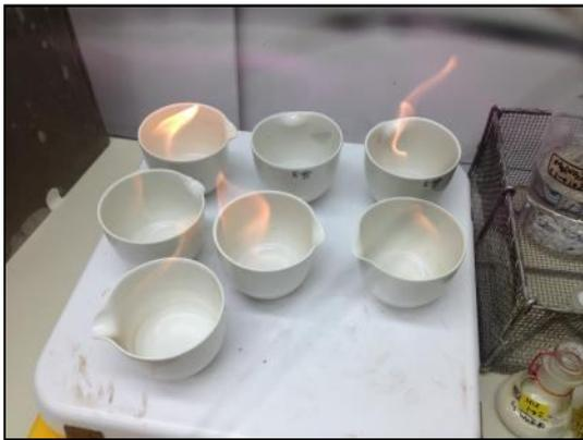
圖 15、加入硝酸鎂乙醇溶液點火。
