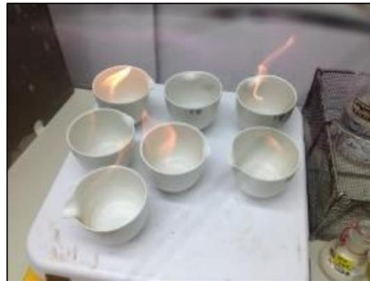
加入硝酸鎂乙醇溶液點火
