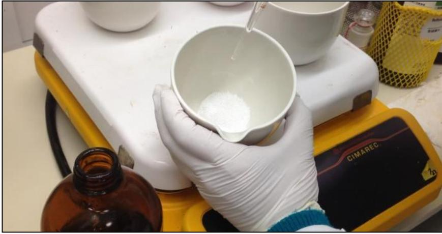
圖 30、以稀硫酸溶液潤濕檢品。
