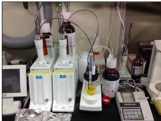
圖 47、KEM MKA-610 容量法卡式水份自動測定儀外觀。
