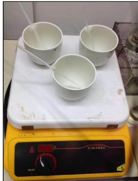
圖 39、以加熱板加熱使殘留物溶解。
