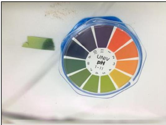
圖 42、以 pH 試紙測試溶液 pH 是否達 8-9。
