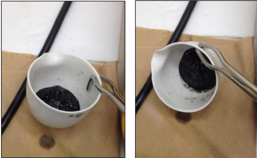
圖 31、以坩鍋夾夾起坩鍋輕敲底部側緣翻攪坩鍋內之檢品
