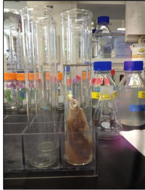
圖 63、加入 0.01N 鹽酸溶液使液面至透析管刻線處。
