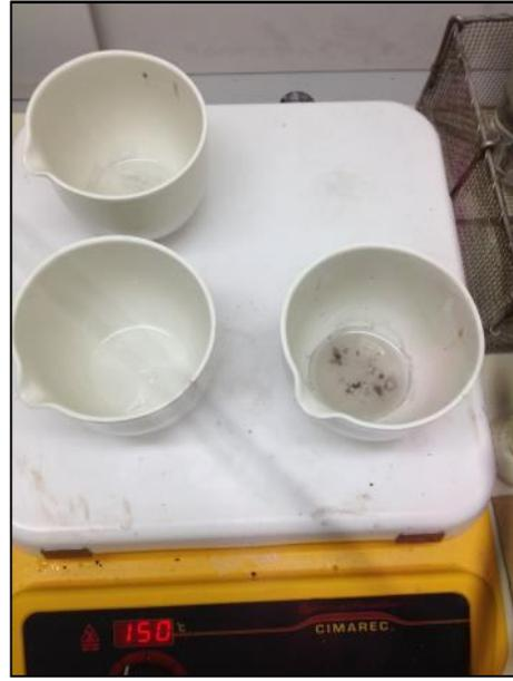
圖 34、若灰化不完全，可再加入稀硫酸溶液及濃硝酸，使用加熱板緩慢地加熱。
