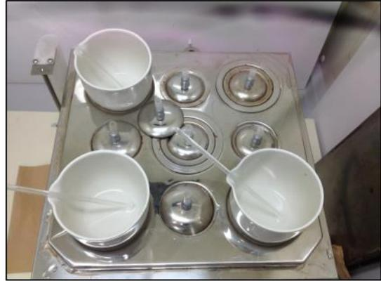
圖 38、沸水浴加熱直到溶液蒸乾。
