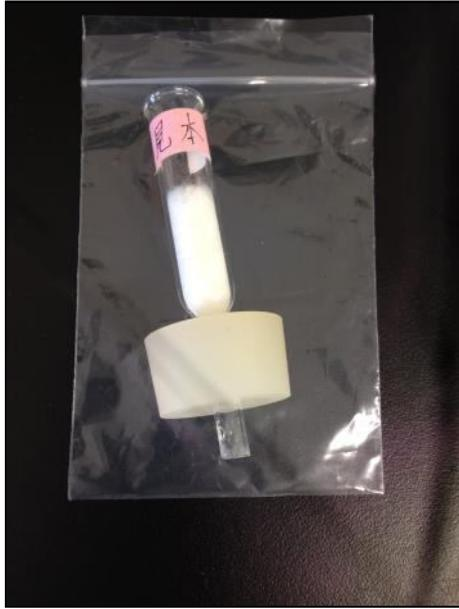
圖 8、排氣管 B 中裝入玻璃纖維棉 F，高度約 30 mm。
