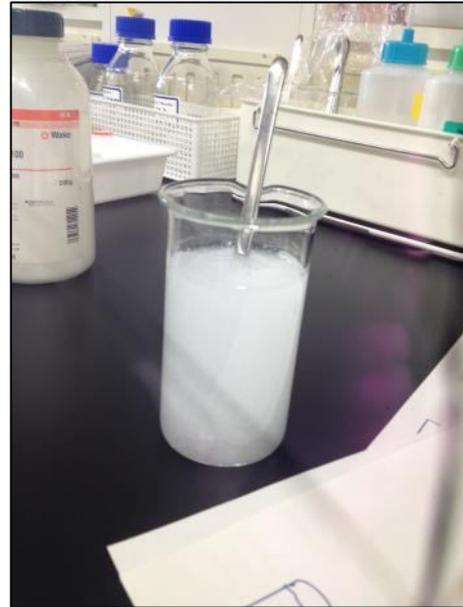
圖 71、取聚醯胺粉末置於燒杯中。圖 72、加入二次水浸濕，以藥勺攪拌。
