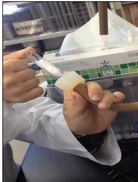
圖 11、利用水流抽氣幫浦將玻璃纖維 F 與排氣管 B 管壁上多餘之混合溶液由排氣管 B 管底部開口抽去。
