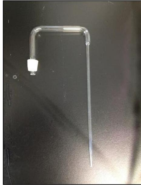
圖 13、將玻璃管 C 垂直地固定於橡膠塞 J。
