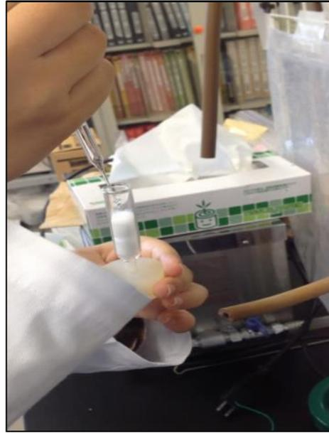
圖 9、以醋酸鉛試液/水混合溶液均勻將玻璃纖維 F 潤濕。
