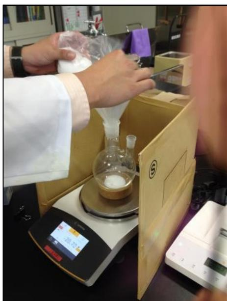
圖 55、取氯化鈉置於蒸餾瓶中。
