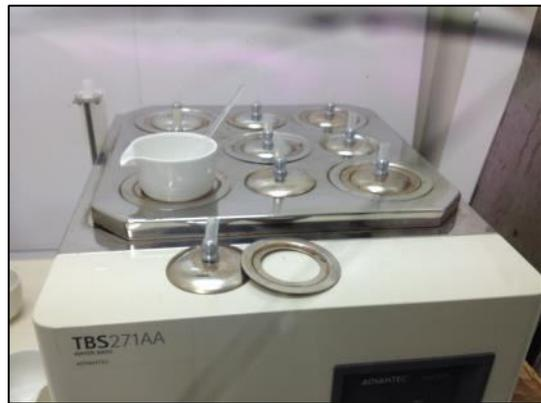
圖 20、沸水浴加熱使殘留物完全溶解。
