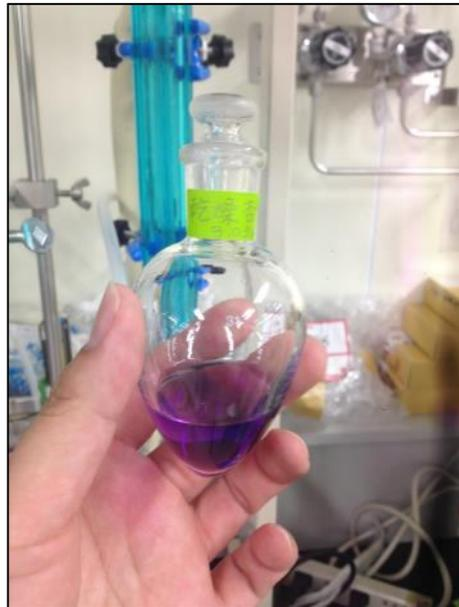
圖 90、產生之二氧化硫氣體被導入至補集用燒瓶中，與過氧化氫反應，產生硫酸，使溶液由綠色(A)變為紫色(B)。
