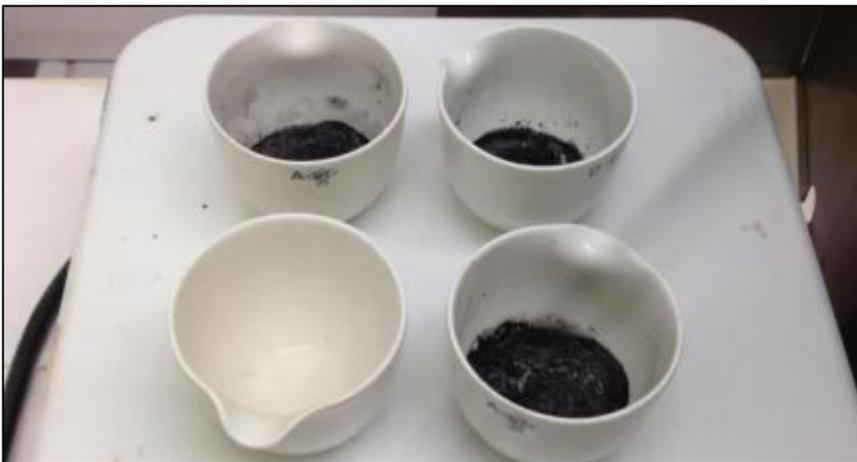
加熱板緩慢加熱至完全碳化(黑色)且白煙不再產生( $\text{SO}_3$ )，移入灰化爐中灰化
