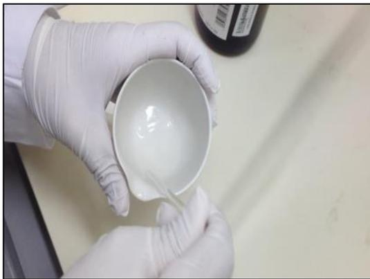
圖 19、使用玻棒來回刮動坩鍋表面以溶解殘留物。
