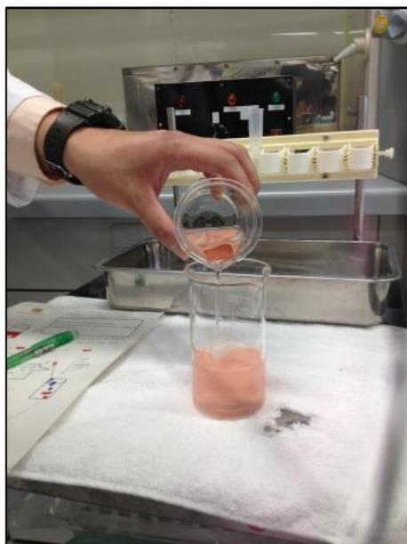
圖 76、緩慢傾斜燒杯倒去大部份水層。
