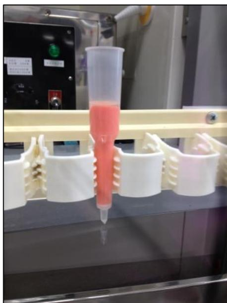
圖 78、將吸附有著色劑之聚醯胺胺粉末移入塑膠管柱中。
