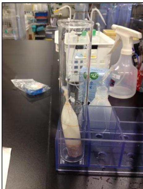
圖 53、將透析膜置於 200 mL 透析管中。
