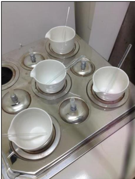
圖 35、沸水浴加熱使殘留物溶解。
