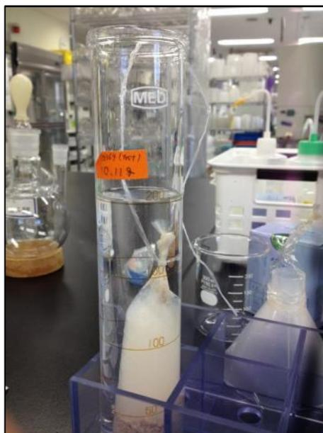
圖 54、加入 30% 甲醇溶液使液面至 200 mL 刻線處。
