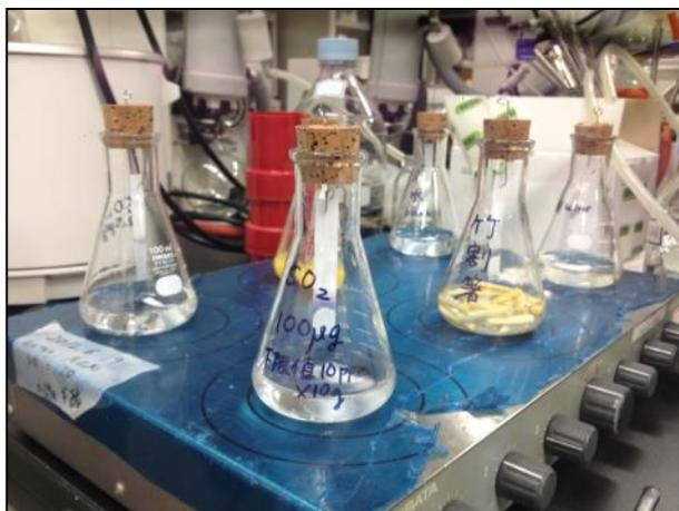
圖 88、以懸掛有碘酸鉀-澱粉試紙的軟木塞塞住錐形瓶開口。
