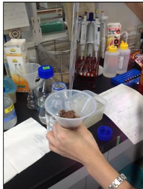
圖 61、加入含 10% 氯化鈉之 0.01N 鹽酸溶液於透析膜內。
