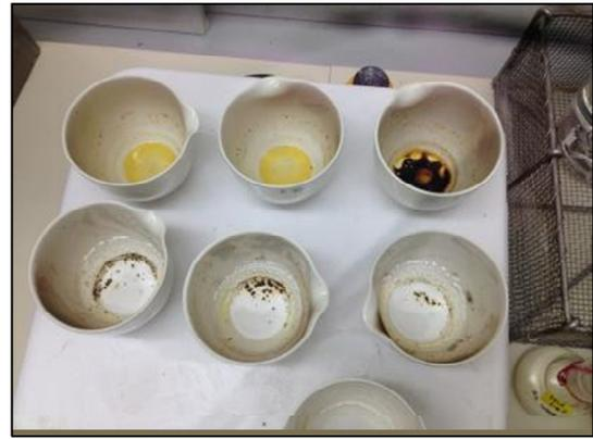
圖 16、緩緩加熱至 450-550°C，使坩鍋內液體蒸乾。
