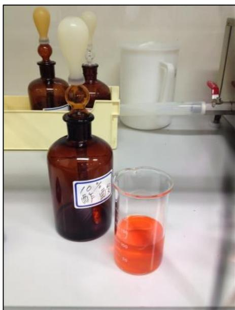
圖 67、以 10%醋酸溶液調整 pH 至約 3-4。
