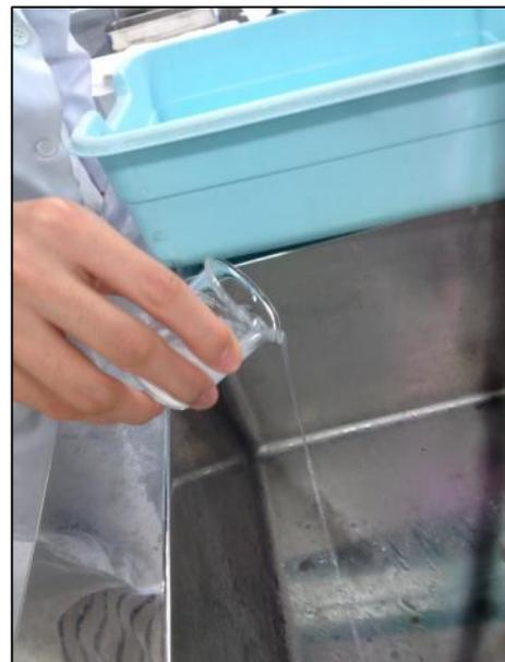
圖 73、待聚醯胺粉末沈降於燒杯底部。圖 74、緩慢傾斜燒杯倒去水層。
