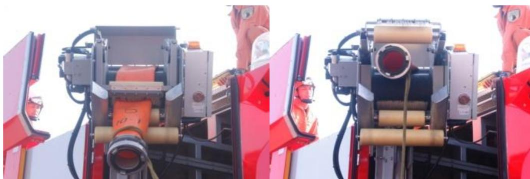
圖 67. 該部隊遠距送水車水帶自動回收清潔閘口。
