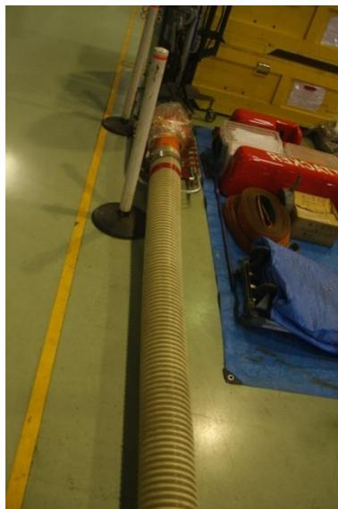
圖 61 直升機機腹外掛式空中滅火水箱汲水管。
