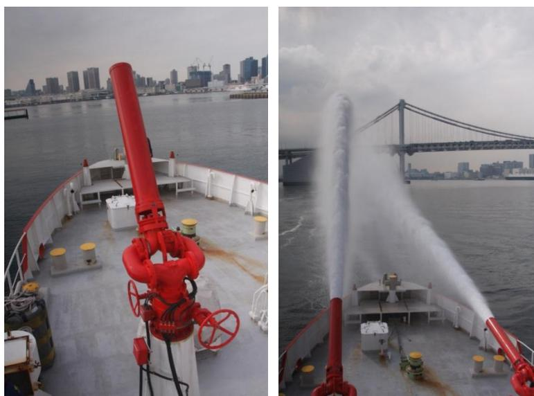
圖 36. 臨港消防署消防船「Miyakodori」消防砲塔近照及射水情形。
