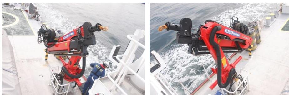
圖 44. 該船左右舷均配置曲折吊臂。
