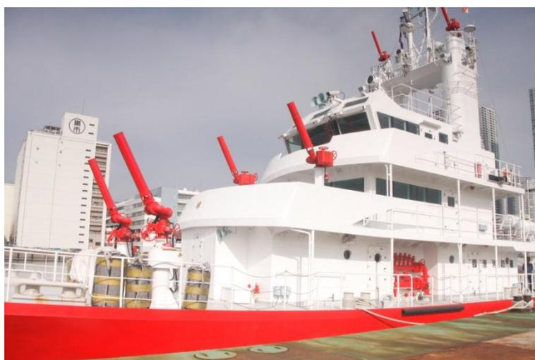
圖 35. 該船配有 3 層 6 具消防射水砲塔。
