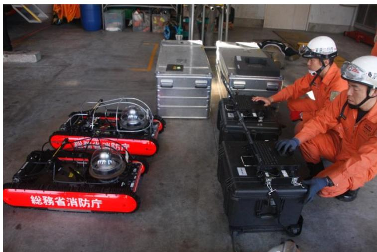
圖 55. 遠距遙控移動式攝影機。
