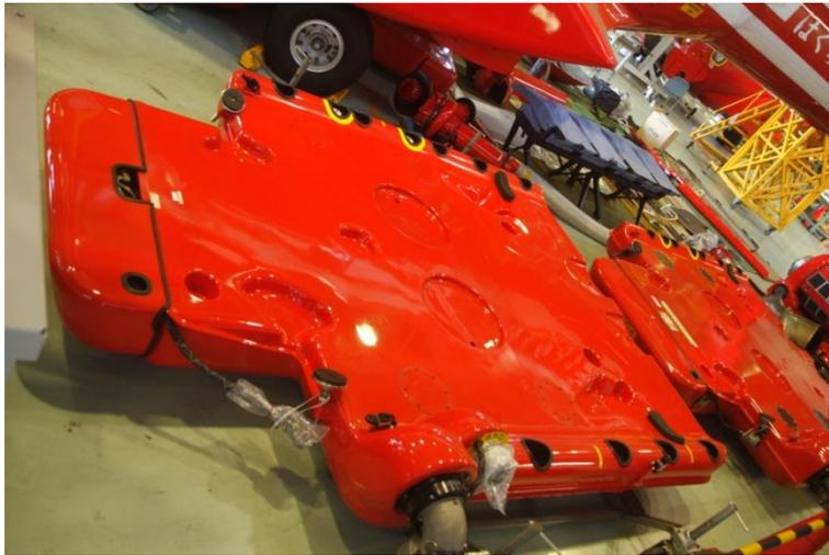
圖 60 直升機機腹外掛式空中滅火水箱。
