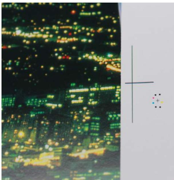
KHS-AI 具有特定的印版濃度測量點(如右圖)，印版製作時需特別注意。
