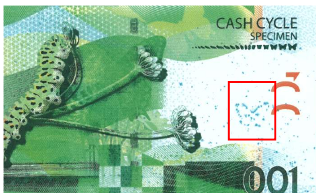
圖 36 清漆裂痕產生之痕跡
