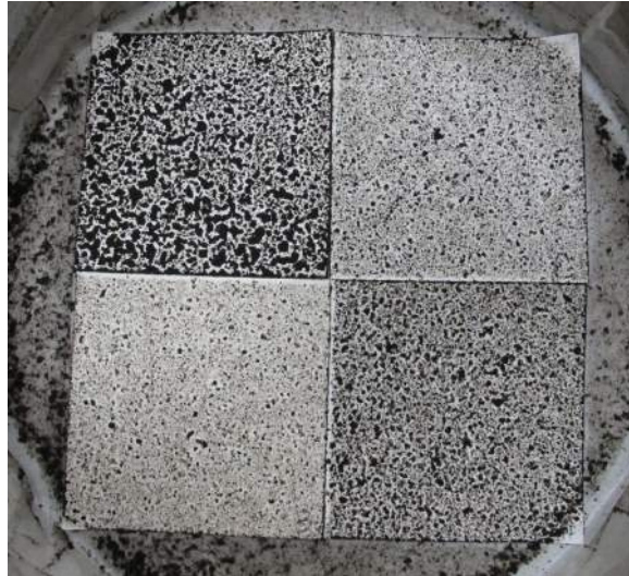
圖 9 以石英球髒污測試同時比較四種安全紙張
