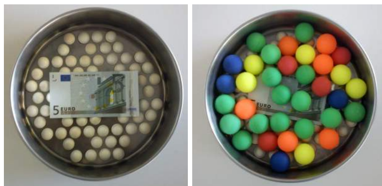
圖 10 彈跳球髒污測試示意圖
