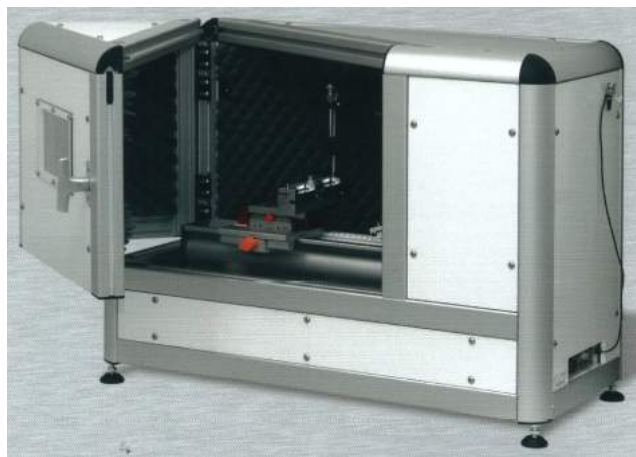
圖 27 BSA-1 聲音評估儀器
