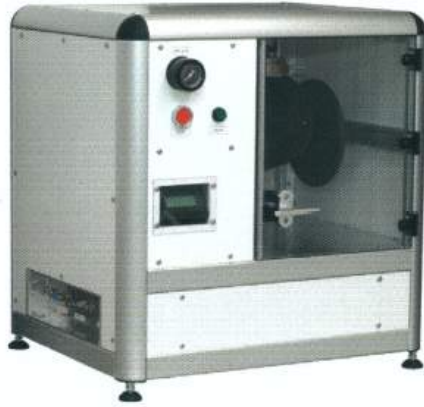
圖 22 揉捏測試儀器 LTT-1
