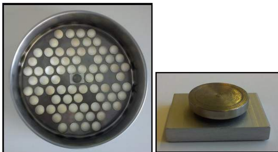
圖 16 LCT 試驗之旋轉基座
