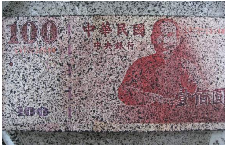
圖 8 石英球髒污測試後試片情形
