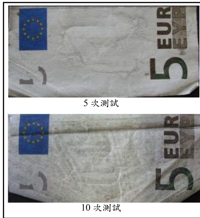
圖 12 彈跳球髒污測試後之試片
