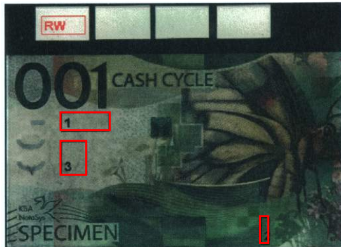
圖 26 OSA-1 掃描後可進行試片量測區域之圈選
