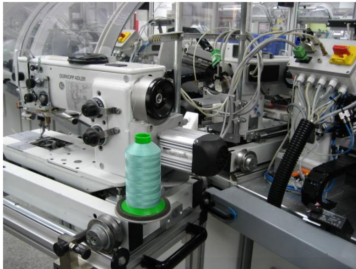
圖 2 占用 PA2000 線上四組縫紉機其中一組連接線進行測試。
