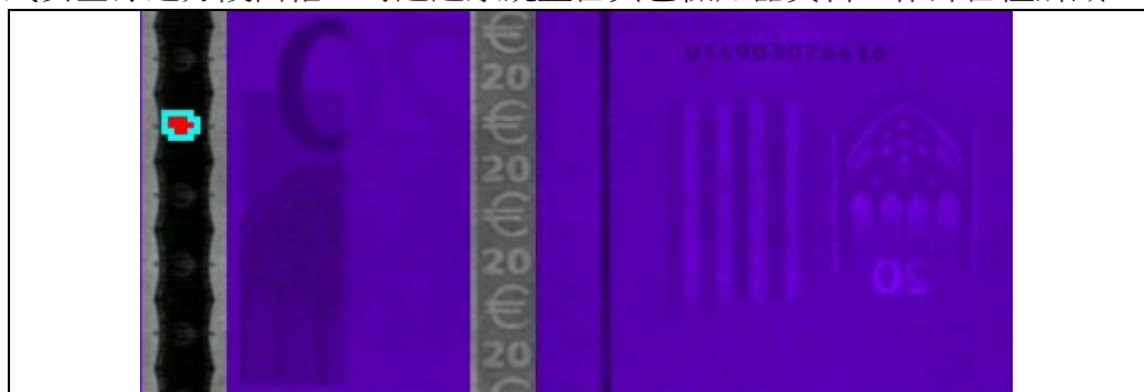
圖 31：IR 透射檢出之瑕疵影像
