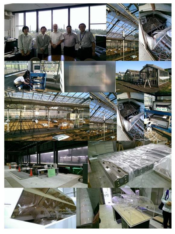
許多模型內部設置有很多風壓量測管,量測管則連接到模型表面之孔洞,以作為 表面風壓量測之用。
