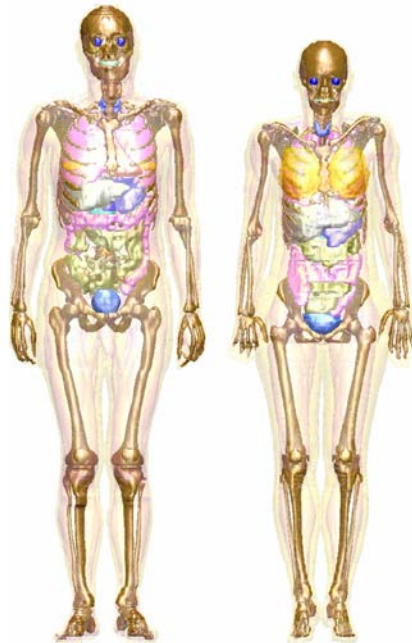
圖 14 國際輻射防護委員會於 ICRP-110 號報告提出之參考人體素假體
