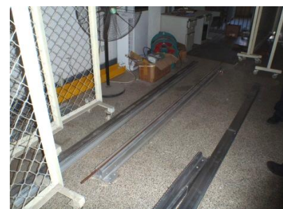
待測溫升試驗之導電軌
