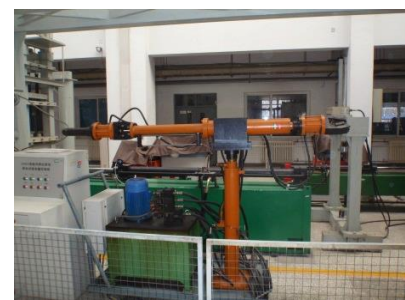
控制拉力之液壓設備
