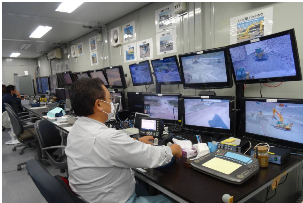
圖 77 各項工程都以施工人員安全為首要考量，無人化施工技術為世界首創。
