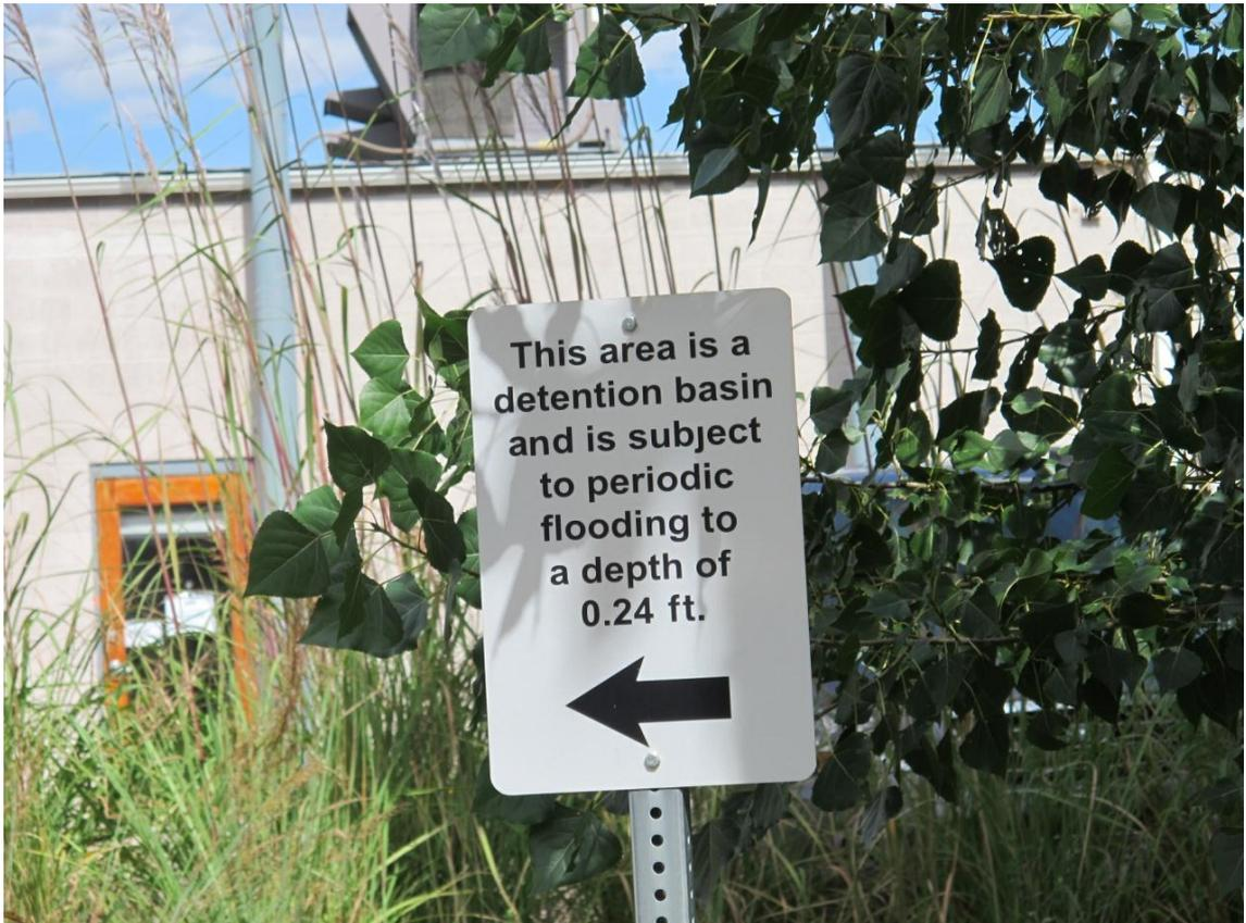
圖 貳-29 告示牌說明設計之降雨深度
