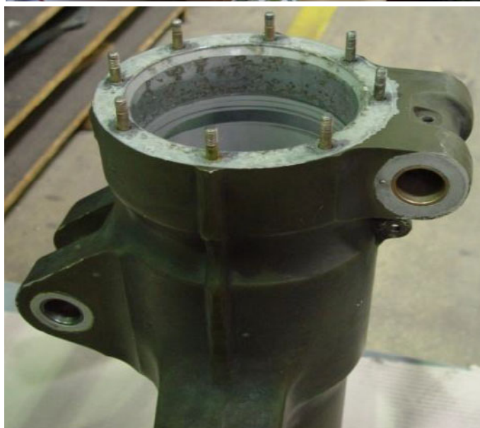
圖 6 冷噴鋅噴塗應用實例照片 (1,4) (a) 管件外部噴塗 (b) 管件內部噴塗 (c) 鋁管外部各種金屬噴塗 (d)、(e) 近似成形及加工 (f) 待修航空用零件
