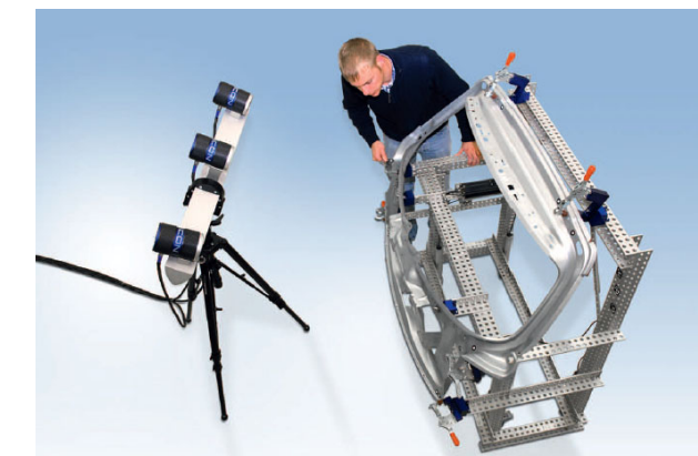
圖8 移動式光柵式掃描量測情形 (6~9) (a) 定位用CCD鏡頭 (b)、(c) 接觸式測頭 (d) 量測情形
