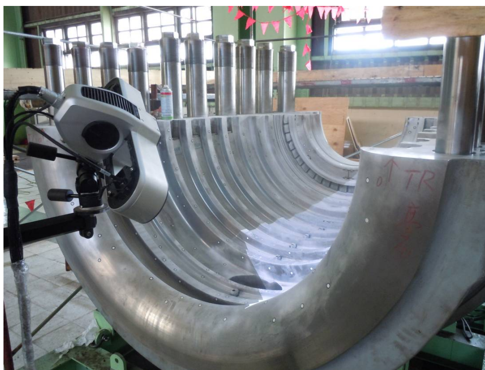
圖 7 綜合研究所現有量測及建模設備量測情形 (a) 三次元量測 (b) 光柵式掃描設備拍攝
