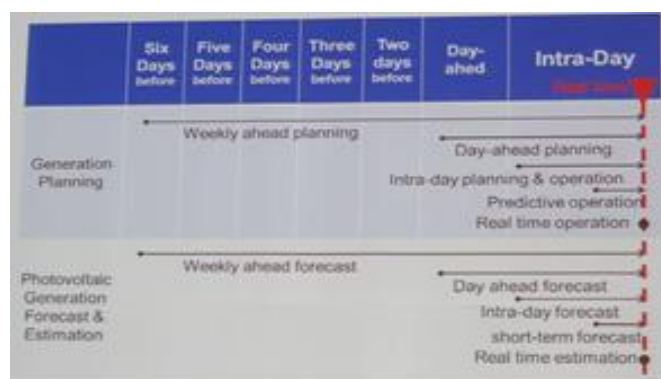
圖二十七、METI 計畫假定之運轉排程，包含當天到六天前的發電規劃以及太陽光電發電量預測與估算。Source: 東京大學 Kazuhiko Ogimoto 教授 WCPEC-6 投影片。
