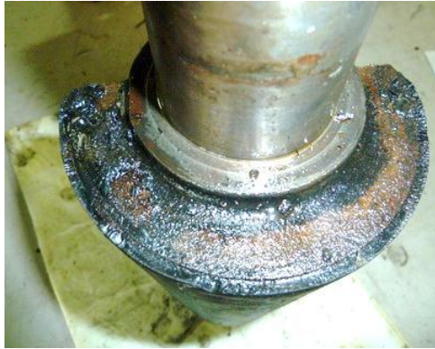
三通閥閥軸(PLUG)側邊橡膠 coating 脫落之情形 舊三通閥閥體(BODY)
