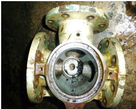
三通閥閥軸(PLUG)側邊橡膠 coating 脫落之情形 舊三通閥閥體(BODY)
