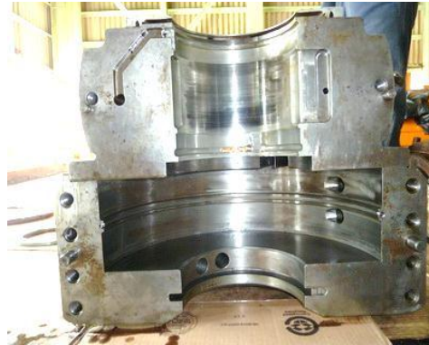
#1 軸承及推立軸承下半吊出
