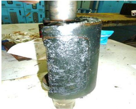
三通閥閥軸(PLUG)橡膠 coating 脫落之情形
