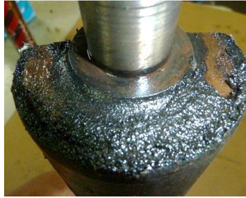
三通閥閥軸(PLUG)側邊橡膠 coating 脫落之情形 舊三通閥閥體(BODY)
