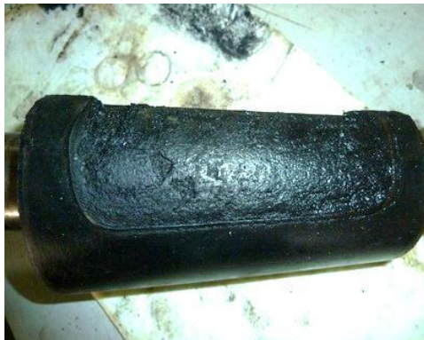
三通閥閥軸(PLUG)橡膠 coating 脫落之情形
