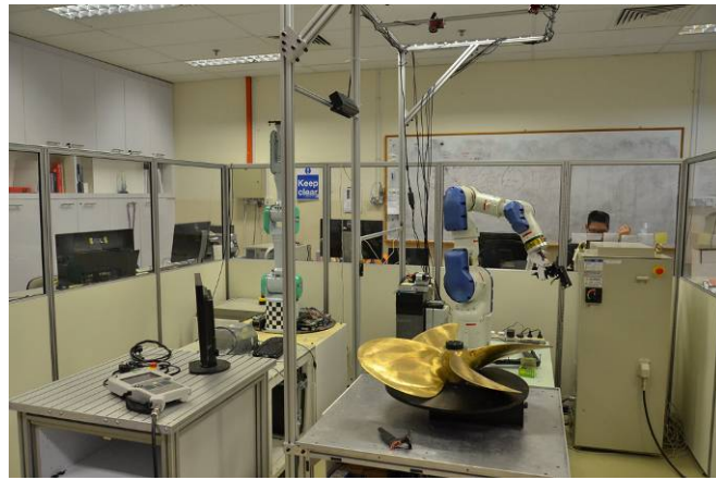
圖 16 利用機器手臂進行螺旋槳去毛邊
