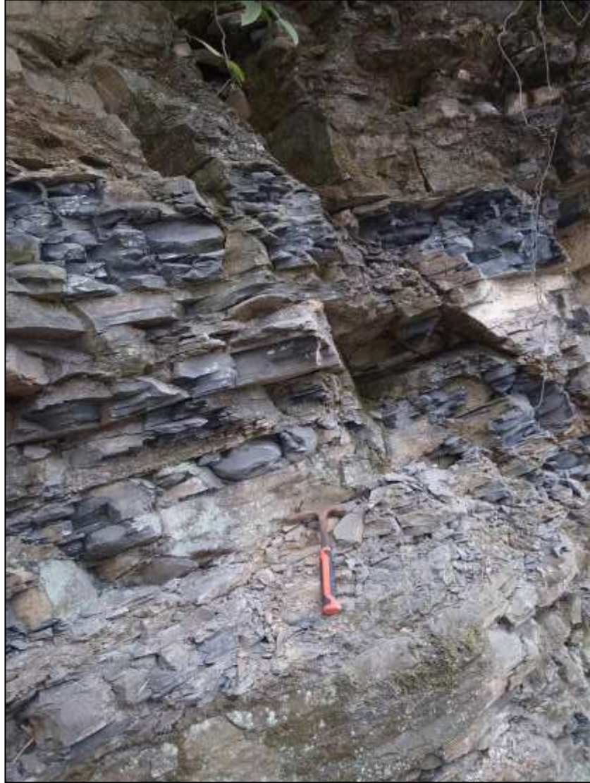
圖五、焦坑組灰粉砂岩。圖中灰粉砂岩和碳質泥岩互層排列，右側地層疑似受斷層截切。
