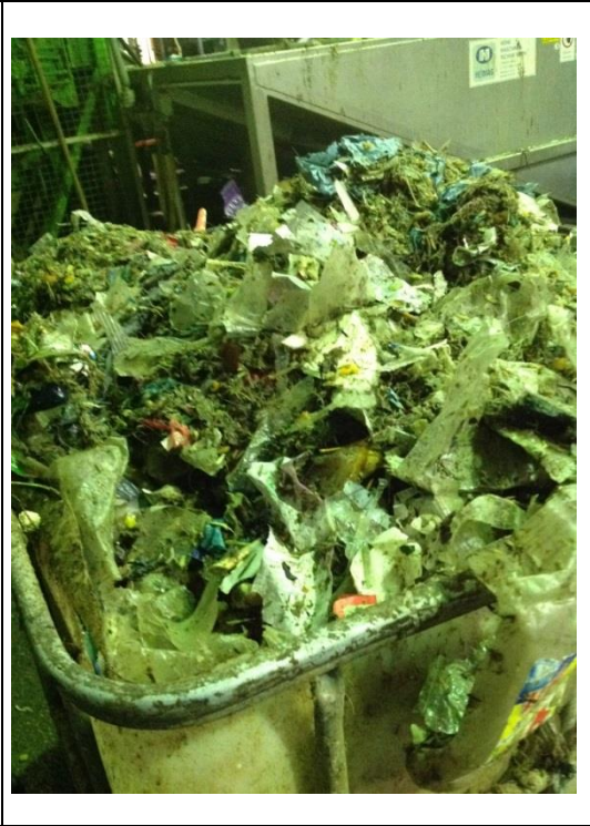
圖 21 破碎分選篩除塑膠包裝材料
