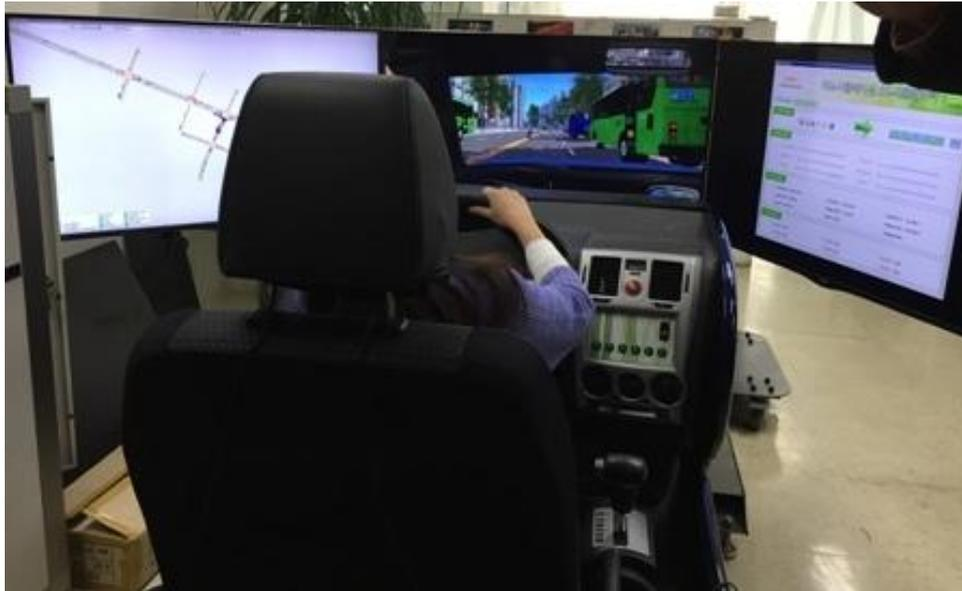
圖 7、INNOSIMULATION Inc. i-DRIVE CDS三個螢幕模型(同行人員實際體驗駕駛狀況)
