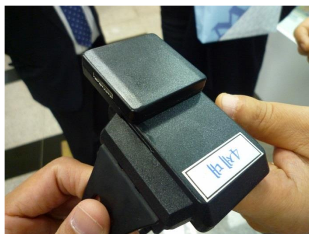
圖 6.20 位置追蹤電子裝置採無線充電方式充電
