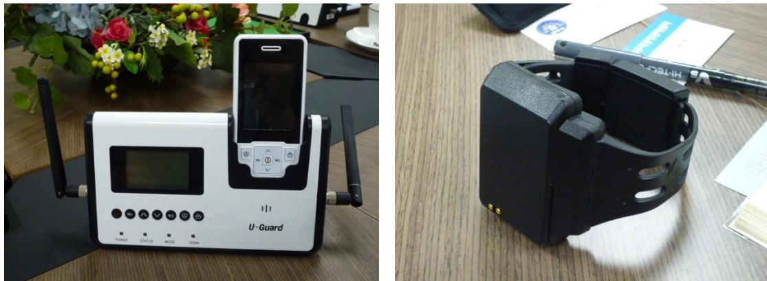
圖 6.18 韓國位置追蹤電子裝置（左：手機式追蹤裝置及在宅監督裝置、右：腳鐐）
