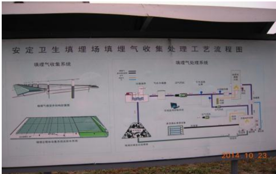
圖 3.2-28 第一期掩埋區沼氣收集、燃燒流程
