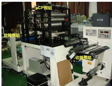
圖三、上圖：本團隊與金屬中心合作開發中的工業級 R2R μCP 印刷設備；右圖：此次交流擬進行實驗之芬蘭工業級軟性電子印刷線 MAXI
