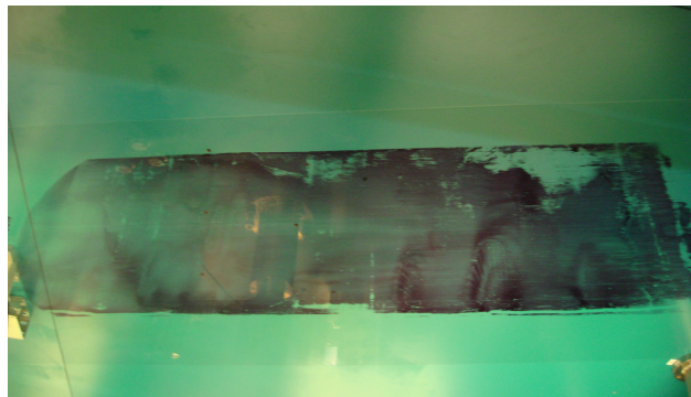
圖七、P3HT 高分子薄膜整片轉印至 PET 軟板的結果
