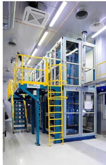
圖三、上圖：本團隊與金屬中心合作開發中的工業級 R2R μCP 印刷設備；右圖：此次交流擬進行實驗之芬蘭工業級軟性電子印刷線 MAXI
