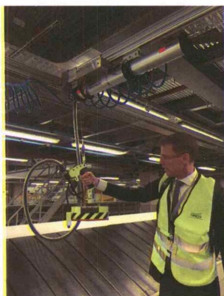
圖十一：出境行李處理氣壓式真空吸盤，以減輕地勤人員工作負擔
