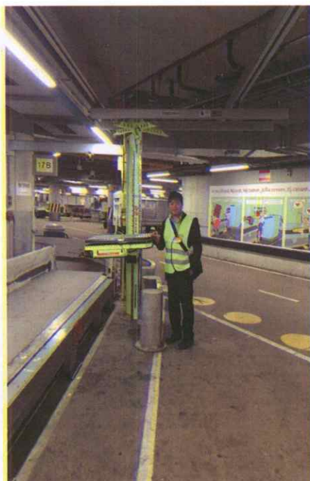
圖十：入境行李處理氣壓式滾輪平台，以減輕地勤人員工作負擔
