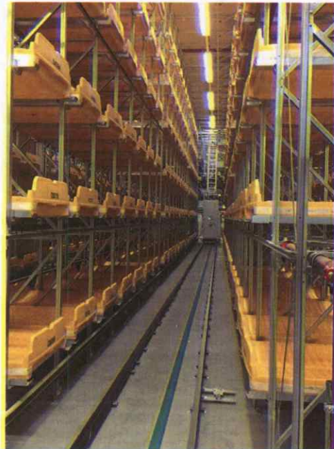
圖十二：早到行李儲存區搭配機械手臂進行行李處理作業
