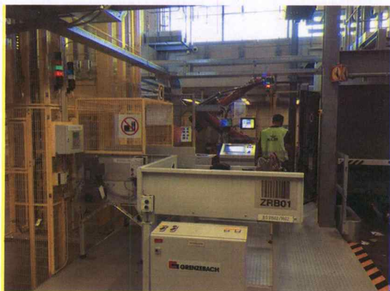
圖十三：機械手臂進行行李處理作業
