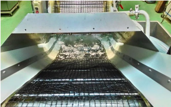
圖十四、設備運用不同密度氣泡及水產生水流達徹底清洗的效果
