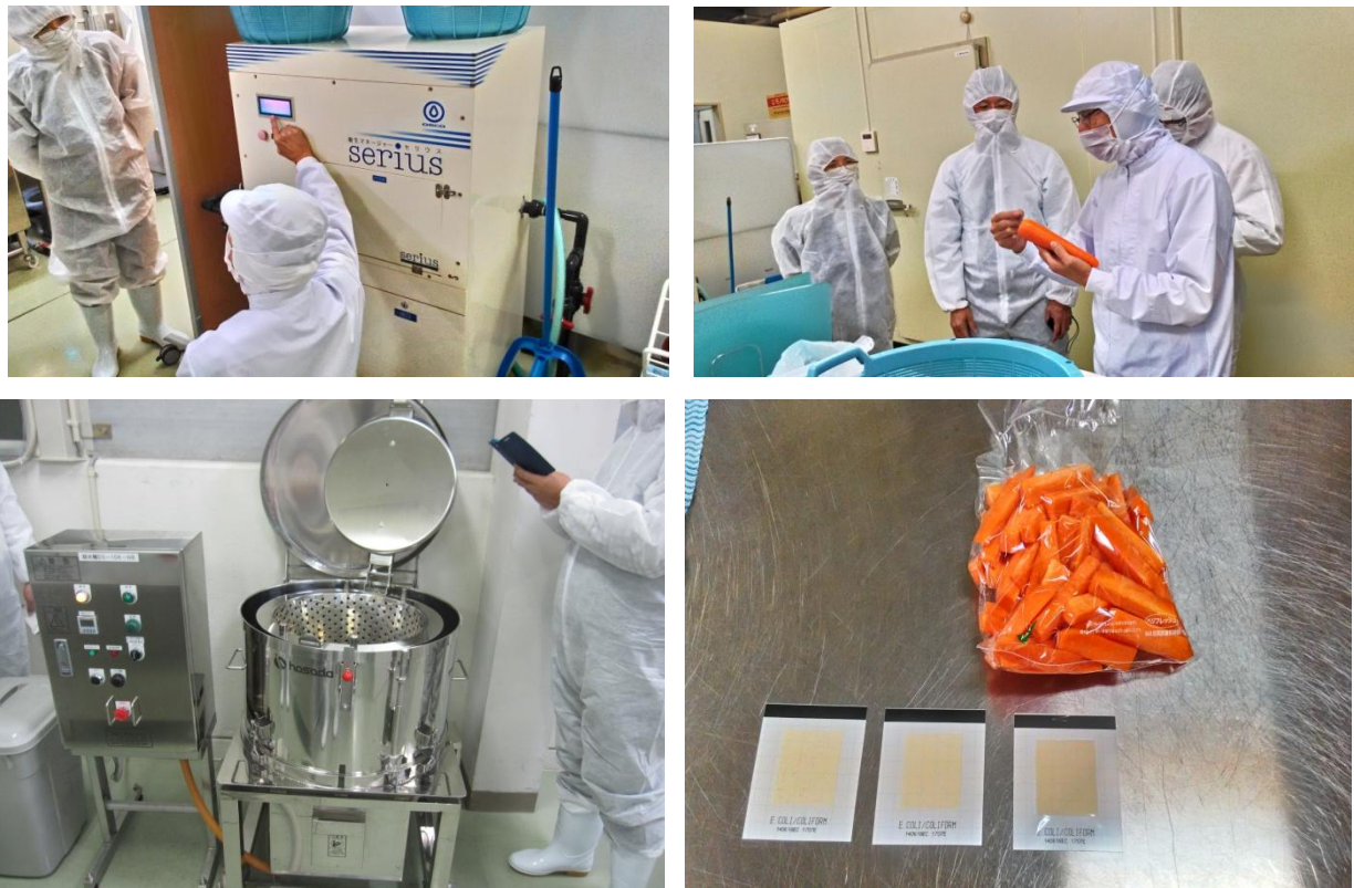
圖六、蔬果汁加工廠導入電解水製造設備用於產品及製程殺菌
