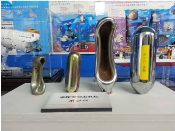
高壓實驗水槽棟 受高壓後，金屬產生之形變。
