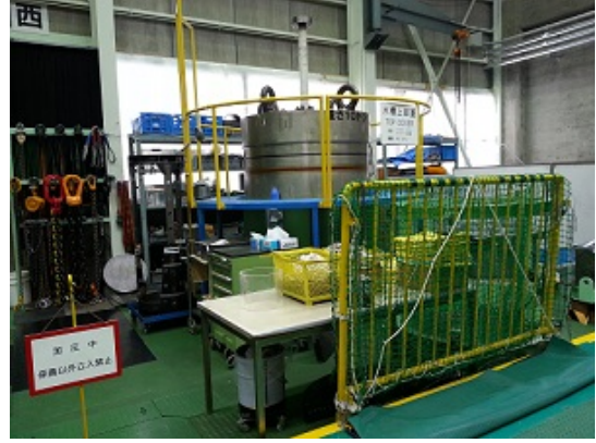
高壓實驗水槽棟 高壓水槽蓋子。
