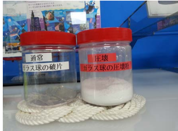
高壓實驗水槽棟 玻璃受高壓後，呈現粉末狀。
