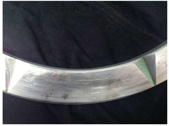
推力磨損情形
