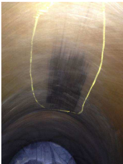
缸套內部磨損情形
