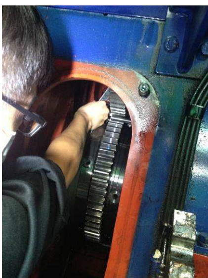
正時齒輪間隙量測
