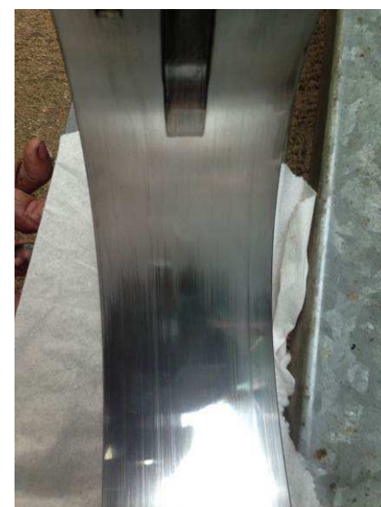
主軸承下軸瓦磨損情形
