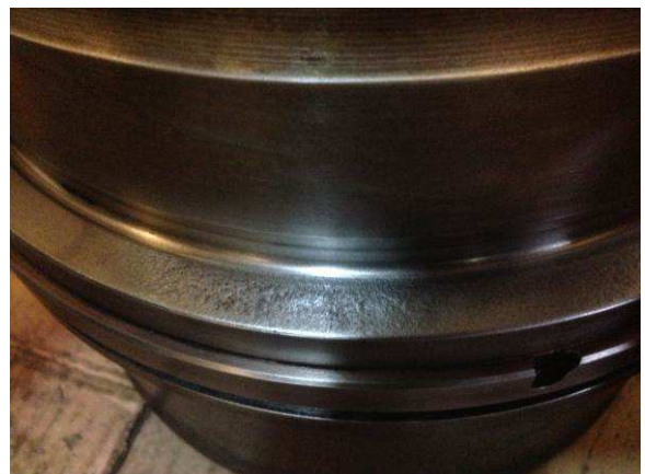
Liner 腐蝕情形
