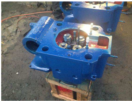
缸頭檢修完後噴漆
