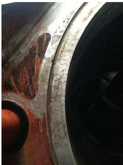
機台腐蝕情形
