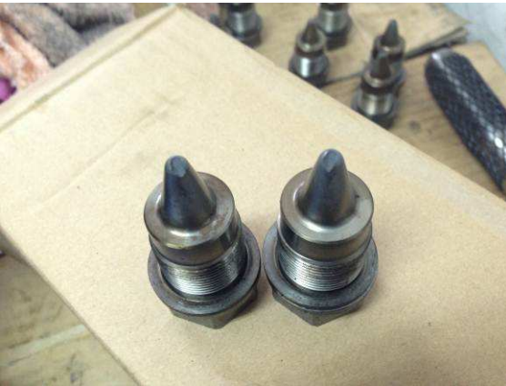
沖蝕螺栓磨損情形
