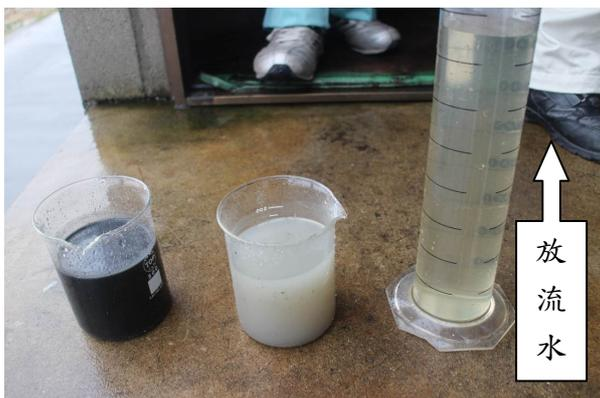
放流水之水色明顯較原水澄清許多（如圖 5），水質經檢驗後，懸浮固體小於 10 mg/L、化學需氧量小於 30 mg/L、生化需氧量小於 20 mg/L，顯示 SBC 技術對超高濃度廢水有良好之
