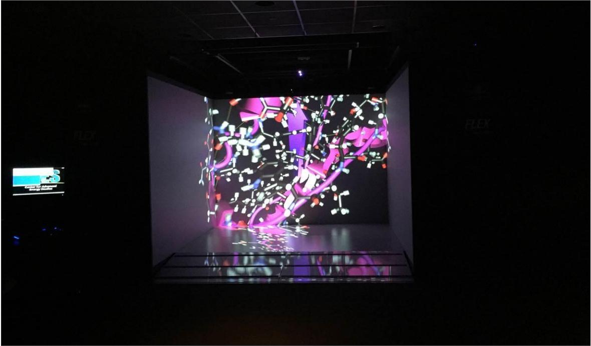
圖二十四、電腦輔助虛擬實境屬於洞穴型四面(左、右、前、下)虛擬實境設施，可以展示核電廠除役、醫學放射成像、輸配電系統、地理環境調查等場景
