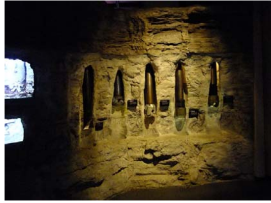
圖三十 鑽採用的各式鑽頭
