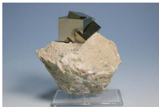
圖十四 黃鐵礦具穿插雙晶結構
