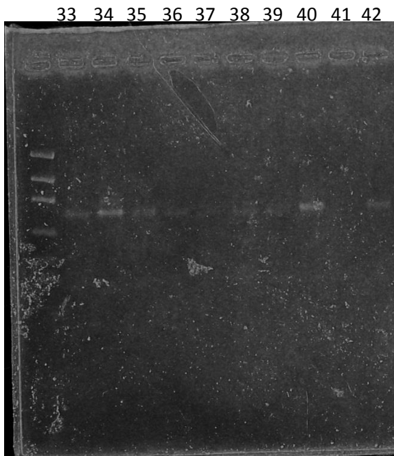
圖四、利用特定真菌引子增幅茶乾内生真菌結果。 Fig4. Dry tea DNA amplified by fungal specific primer.
