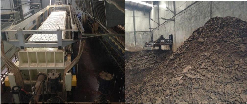
圖 15 污泥高壓脫水機及污泥磚
