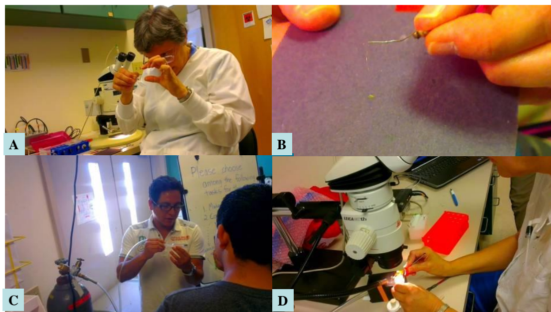
圖1. 2014年至美國農部加州帕里爾分部研習：(A) Dr. Backus 將金絲 (直徑約 25~35 \mu\text{m} ) 與銀膠沾黏至蚜蟲前胸背板的操作示範；(B) 已完成的活體樣本；(C) Dr. Cervantes以CO 2 昏迷大型昆蟲的操作示範；(D) Dr. Backus 以幫浦吸蟲管將葉蟬活體固定的操作示範。
