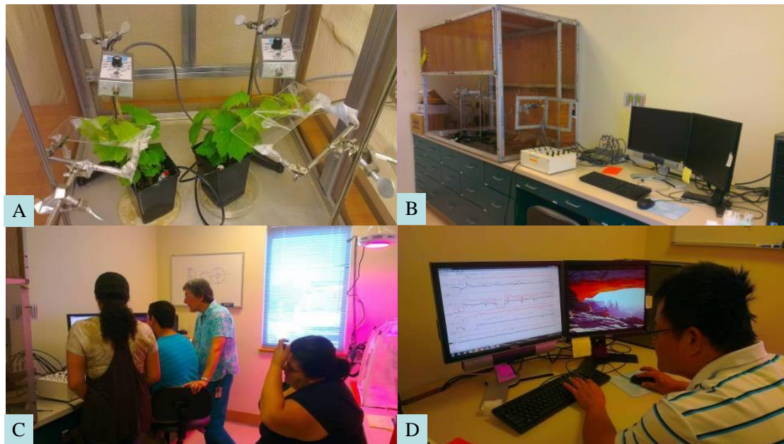
圖2. 2014 年至美國農部加州帕里爾分部研習：(A) EPG 連接昆蟲與植物之操作端設備；(B) EPG 操作端各類設定參數的使用面板；(C)第三代 EPG 發明者 Dr. E. Backus指導波紋判讀方法；(D) EPG 輸出端的電腦分析圖譜。
